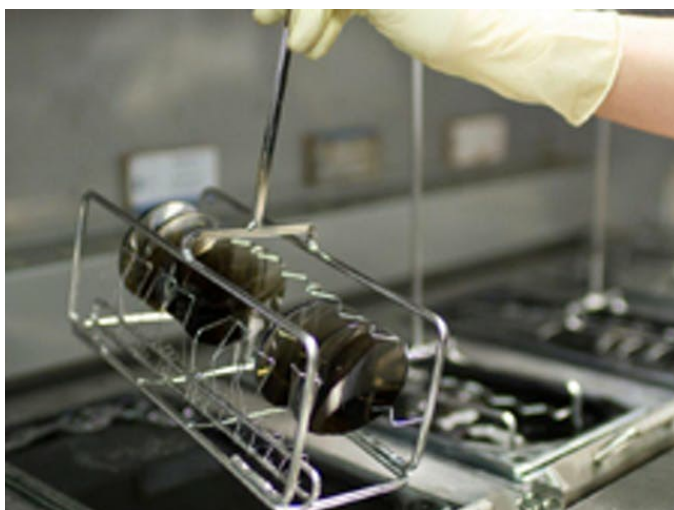
Les verres filtrants spéciaux de ZEISS sont teintés dans un bain d'immersion prévu à cet effet.
