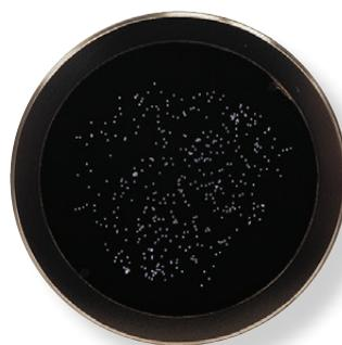
*Каждая звезда подсвечивается мощным светодиодом через отдельный световод из оптоволоконна. Для каждого полушария (северного и южного) используется шестнадцать оптоволоконных блоков.*
