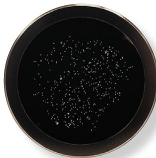
*Cada Estrella recibe luz del LED de alta potencia a través de una sola fibra óptica. Dieciséis bloques de fibra óptica, cada uno para los hemisferios norte y sur, se utilizan para cubrir todo el campo estelar.*
