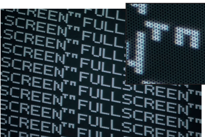
Image projetée avec VELVET/DIGIGON 108 2.4/11.4 (séquence d'images de test) Aberration chromatique : négligeable – moins d'1/4 de la largeur d'un pixel; données d'image : Canon EOS 5D Mk II, ZEISS Macro-Planar 2/100, ISO 800, f/2, 0,4s.
