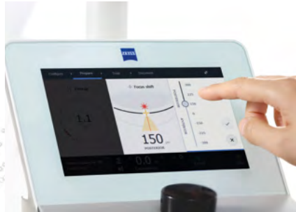
Défocalisation motorisée en fonction de l'application
