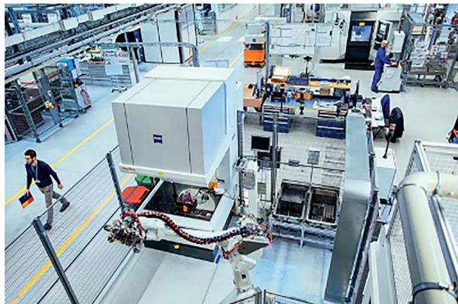
Cellule de contrôle robotisée en flux de production de pales de turbine, installée chez Safran Helicopter Engines, à Bordes (Pyrénées-Atlantiques).
