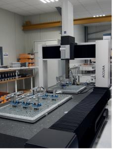
> Le laboratoire se compose de trois MMT Zeiss
