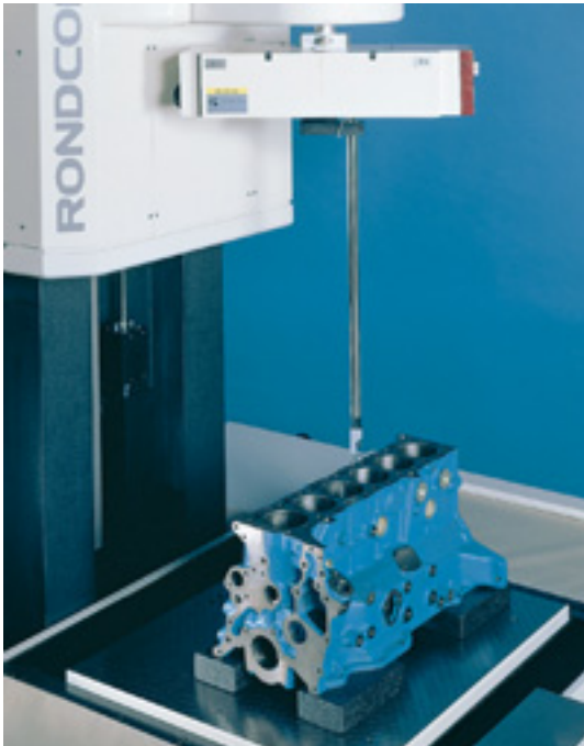
Applications typiques de Rondcom 72/75 : mesure de culasses, de blocs-moteurs et de vilebrequins
