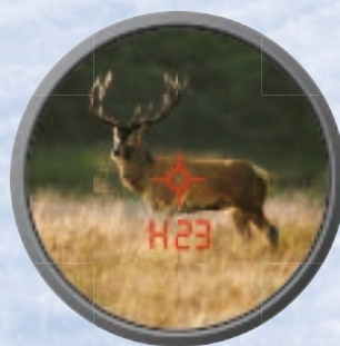
Après l'affichage de la distance, l'écran indique H 23. Le chasseur doit viser 23 cm au-dessus du point d'impact désiré.
